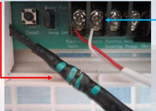
3.2 Collegare con il filo bianco i morsetti dell'elettrovalvola ai primi due morsetti di sinistra della centralina (piccoli con tensione 12V). Se la distanza dalla centralina all'elettrovalvola fosse maggiore della lunghezza del cavo, si prega di sostituire il cavo con uno di sezione più grande.
