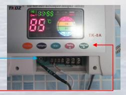
Ora il pannello solare verrà ricaricato di acqua fino al 100%. Successive ricariche le farà automaticamente quando scenderà sotto il 75%. Il funzionamento dopo RESET applica le impostazioni di fabbrica.
